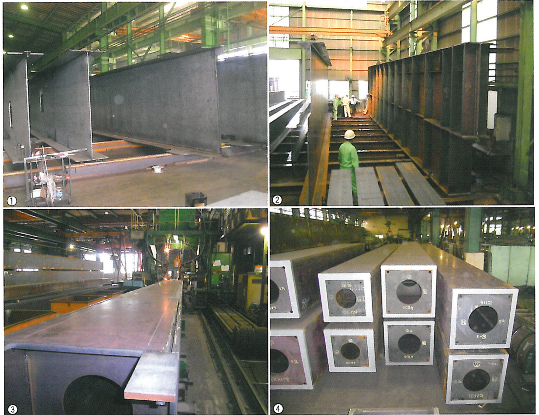
①羽田沖合ジャケット向けビルトH②クレーンガダー用ビルトH ③ビルトボックスへの変更も多い④フル稼働にあるビルトボックス製作
